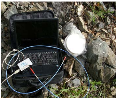
Фиг. 3. Полеви Тематично Ориентиран Многоканален Спектрометър (ТОМС)
